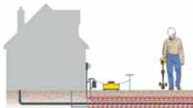
Conecte directamente con líneas de servicios públicos.
